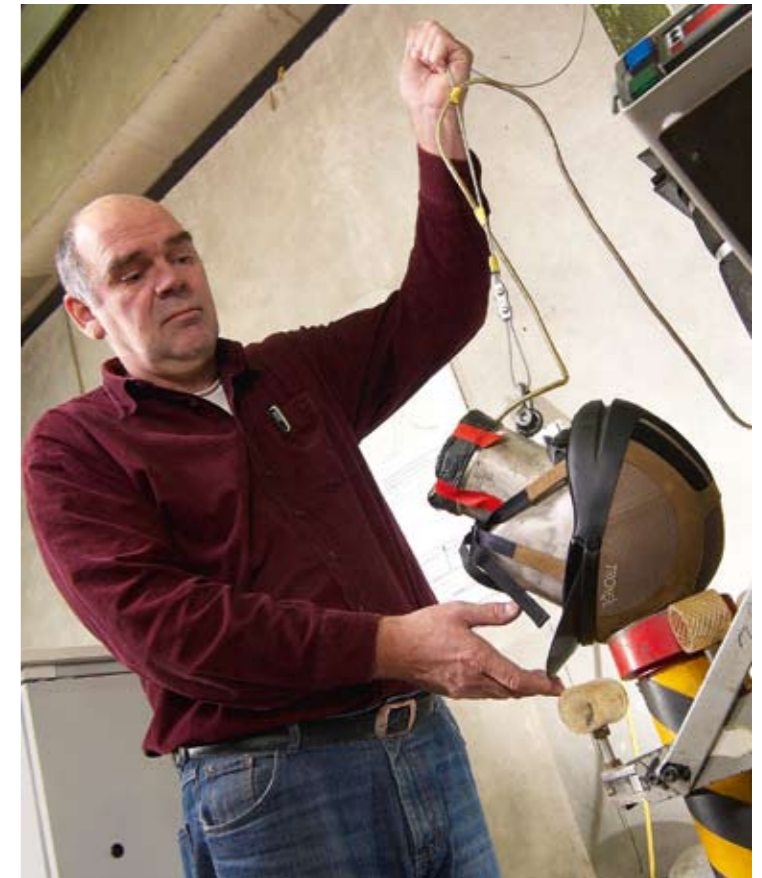
Mit dem Stoßdämpfungstest checkt Prüflingenieur Andreas de Boer, wie gut die Helme den Reiterkopf schützen würden.
